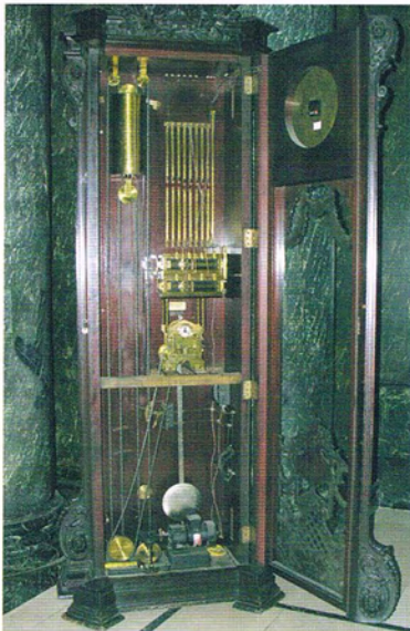
Dank der geöffneten Tür sieht man die ganze Mechanik inklusive des vor einigen Jahren montierten Quarzwerkes auf der Rückseite des Zifferblattes. Bild Robert Simon, November 2008.
